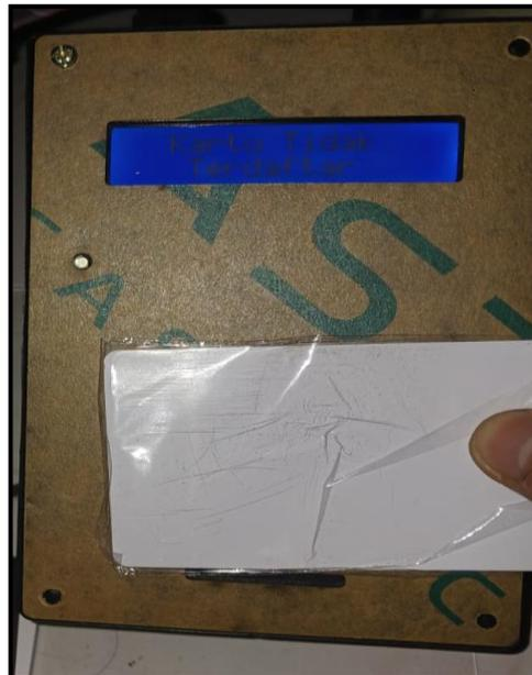
Gambar 4. Pengujian RFID tidak terdaftar
